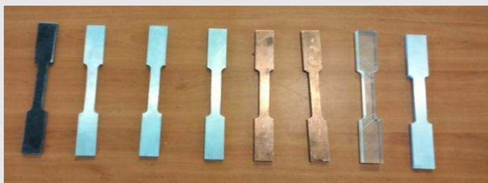
Figura 7. Probetas maquinadas de los tres materiales, acero, aluminio y cobre.
