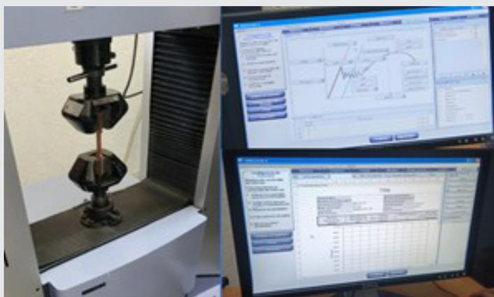
Figura 8. Collage de prueba de tensión en máquina universal.
